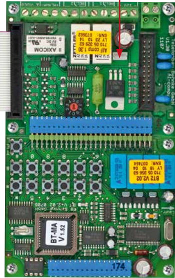
Platine in Behnke Türstation (mit Anschlussinterface AIF)
