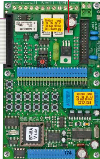
Platine in Behnke Türstation (mit Anschlussinterface AIF)
